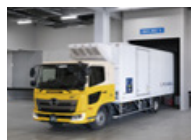
施設開口部と車両の隙間からの外気侵入を防ぐ ドックシェルター
