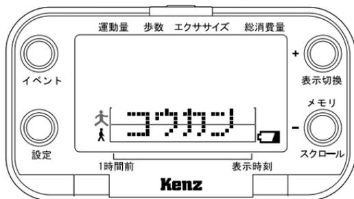
電池がない場合、なにも表示されません。ご利用中、電池の容量が低下すると電池マークを表示します。
