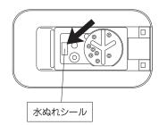
ください。本機は簡易防水対策がしてありますが、内部が水に濡れてしまった場合、修理できませんので、 ご了承ください。内部が水に濡れたかは、図に示す水 ぬれシールの赤い水玉がにじみ、白色部分が赤色に変 色したり、赤い水玉が消失したりすることで確認します。
