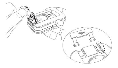
③(ご)部のケースガイド下に正しく入っていることを確認し、USB ケーブル接続部の方へ矢印のように組み込んでスライドさせてください。
